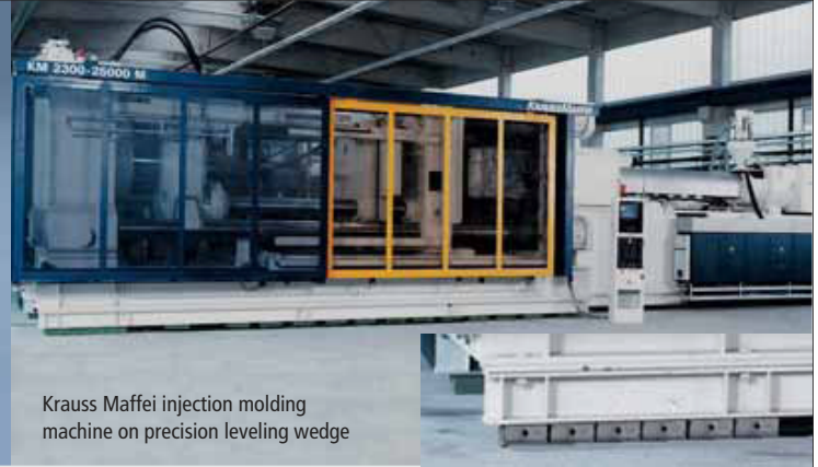
Precision Leveling Wedge
